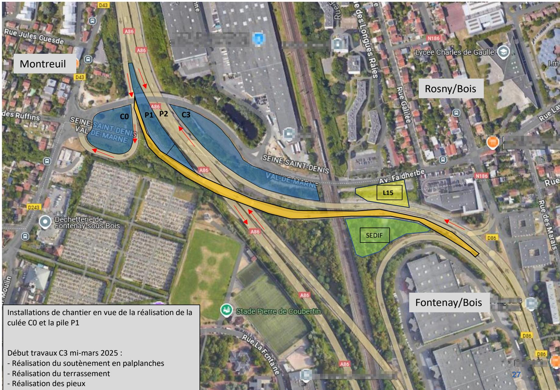
Installations de chantier en vue de la réalisation de la culée C0 et la pile P1
